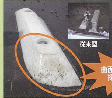
損傷状況を確認して形状決定
